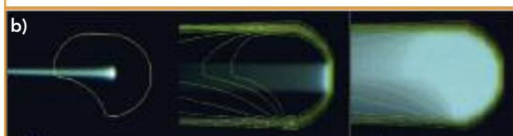
Abbildung 1: 1a: Strahlendosis eines Protonenstrahls entlang der Eindringtiefe in den Körper im Vergleich mit einem Photonendosisverlauf. 1b: Prinzip der am PSI entwickelten Spot-Scanning-Technik: Durch Verschieben und Überlagern der Dosisspots eines Protonenbleistiftstrahls können beliebig geformte Dosisverteilungen erzeugt und die Dosis kann besonders präzise dreidimensional an die Form des Tumors angepasst werden.
